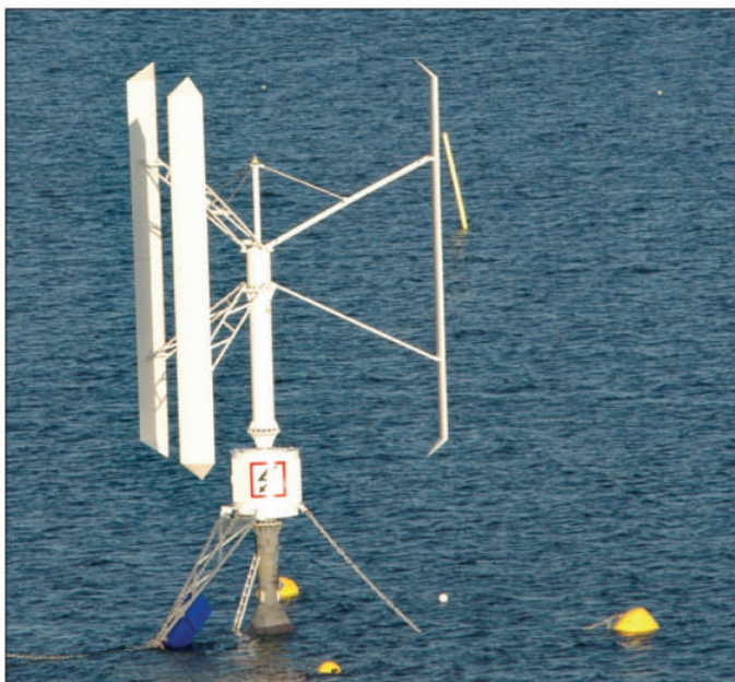
Testanläggningen SeaTwirlS1 utanför Fridhem i Gullmarsfjorden, Lysekil, har funnits på plats sedan sommaren 2015. Då och då har verket provkörts.
